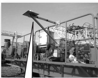
旋回センサー 1個 *使用クレーンの旋回台の外側に張出して取付ける
